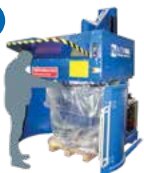
Aufstellen der Hülle
